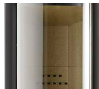
Renfort intérieur en vermiculite.
